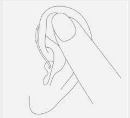
Tap Control funktioniert, indem man zweimal an den oberen Bereich des Ohres tippt.
